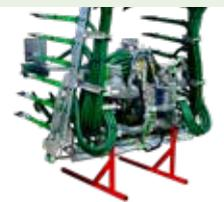
**2 Abstellstützen** ermöglichen ein schnelles Absetzen und eine gute Stabilität beim Lagern der Maschine.
