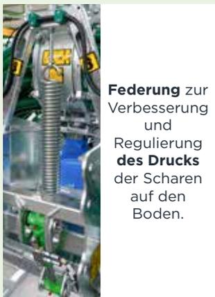
**Federung** zur Verbesserung und Regulierung **des Drucks** der Scharen auf den Boden.
