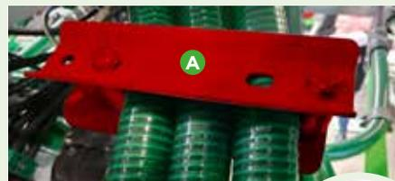
(A) **Einstellbare Blockierung der Einspritzleitungen**, um sie vor Verschleiß durch Vibrationen zu schützen.
